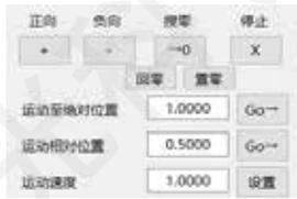
运动控制主要包括以下几种方式:搜零、点动、相对运动、绝对运动。
